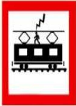
**Влезать на вагоны. Напряжение в проводах достигает 27500 вольт. (дома в электрической розетке- 220 вольт). Смертельный ожог может произойти на расстоянии 1-2 метров от контактного провода!**
